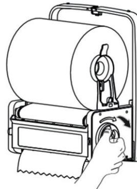
TOURNER LA ROULETTE SUR LE CÔTÉ DU DISTRIBUTEUR DANS LE SENS DES AIGUILLES D'UNE MONTRE POUR INTRODUIRE LE PAPIER DANS LE MÉCANISME.
