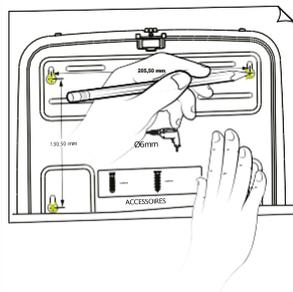
MARQUER LA POSITION AU MUR POUR PERCER LES TROUS DE MONTAGE.
